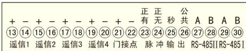
图 2 信号端子接线图
