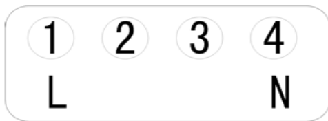
图 7 终端 II 型本体主接线端子示意图
